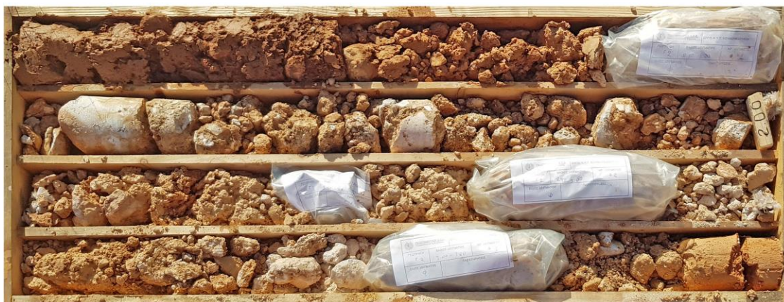
ΦΩΤ. 12 Δειγματοληψία γεώτρησης Γ2 (0,00-4,00 m)
