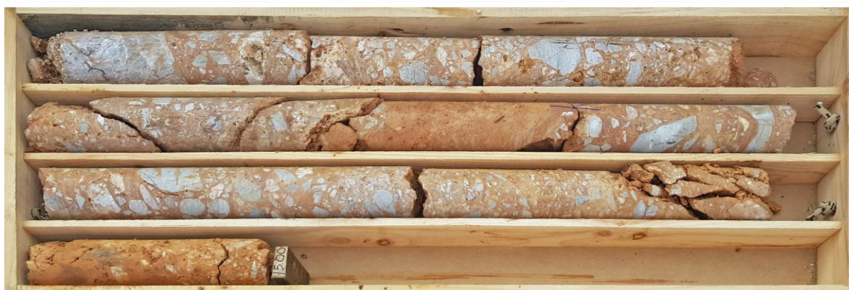
ΦΩΤ. 25 Δειγματοληψία γεώτρησης Γ5 (12,00-15,00 m)
