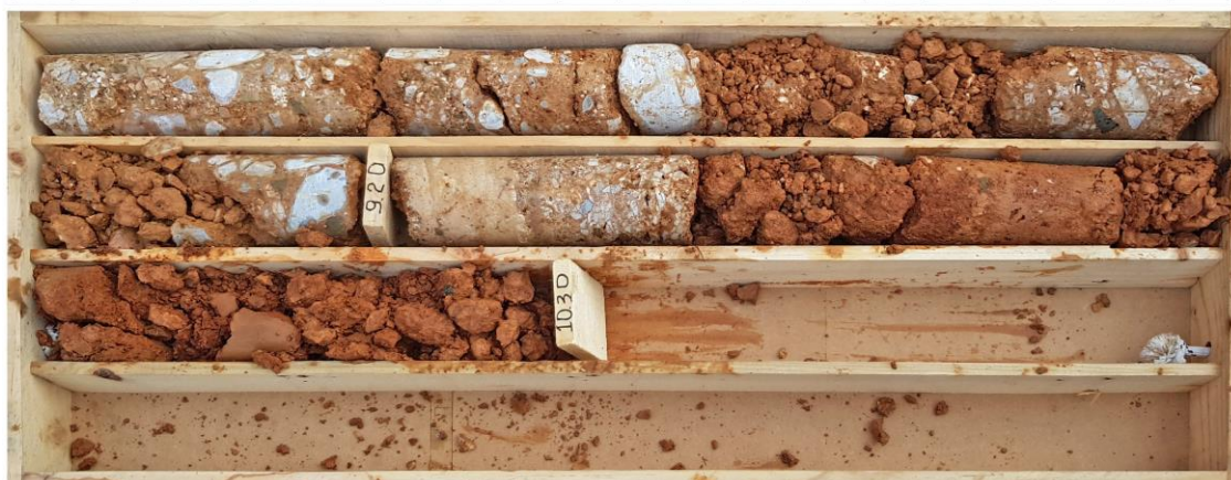
ΦΩΤ. 18 Δειγματοληψία γεώτρησης Γ3 (7,90-10,30 m)
