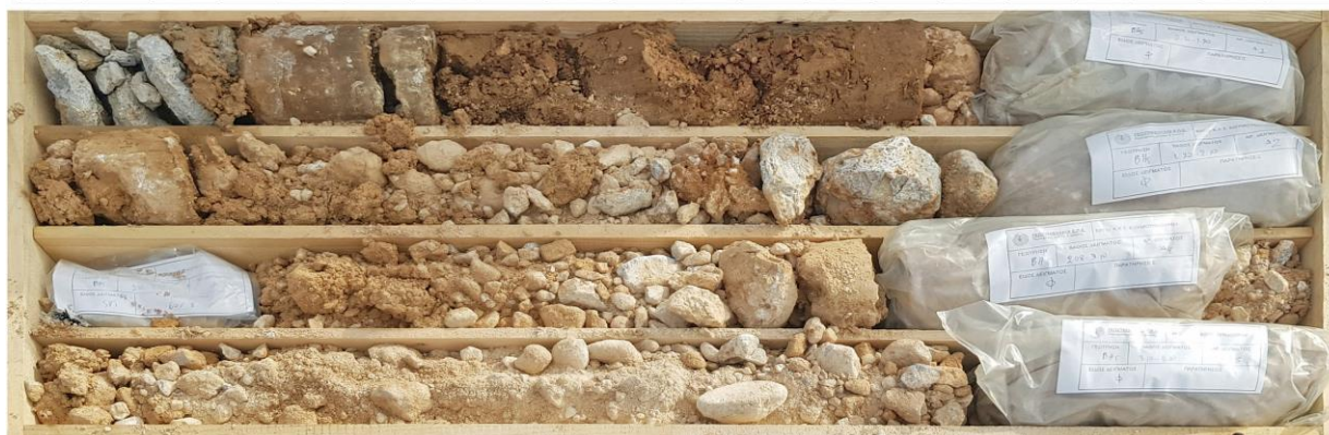
ΦΩΤ. 22 Δειγματοληψία γεώτρησης Γ5 (0,00-4,00 m)
