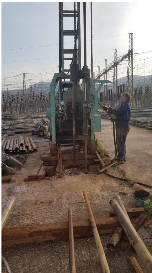
ΦΩΤ. 7 Εκτέλεση πρότυπης δοκιμής διείσδυσης - χειροκίνητα (SPT)
