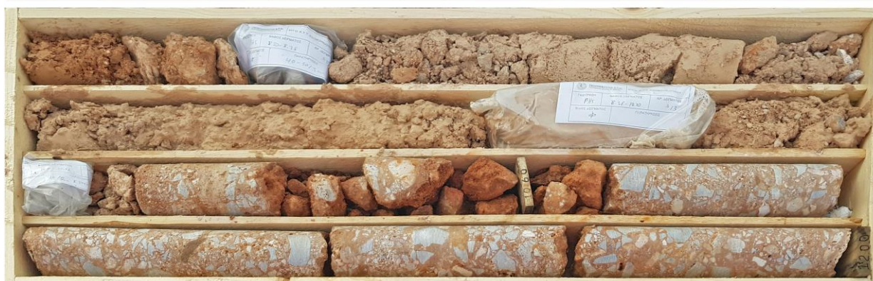
ΦΩΤ. 24 Δειγματοληψία γεώτρησης Γ5 (8,00-12,00 m)
