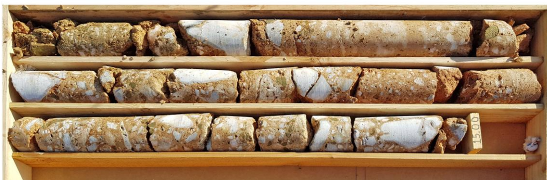
ΦΩΤ. 15 Δειγματοληψία γεώτρησης Γ2 (12,15-15,00 m)
