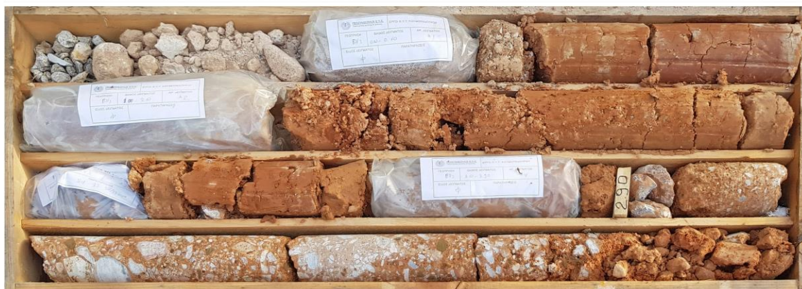
ΦΩΤ. 16 Δειγματοληψία γεώτρησης Γ3 (0,00-4,10 m)
