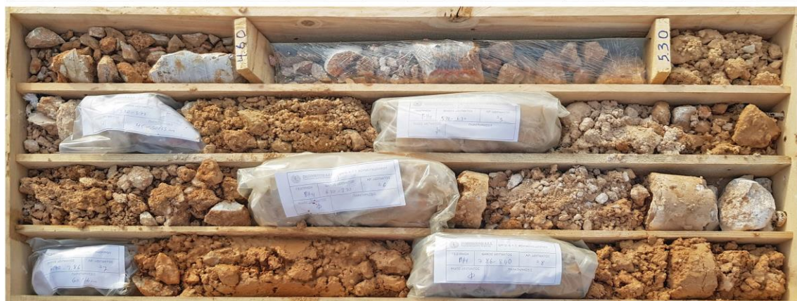
ΦΩΤ. 20 Δειγματοληψία γεώτρησης Γ4 (4,20-8,70 m)
