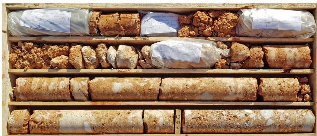
ΦΩΤ. 13 Δειγματοληψία γεώτρησης Γ2 (4,00-8,00 m)
