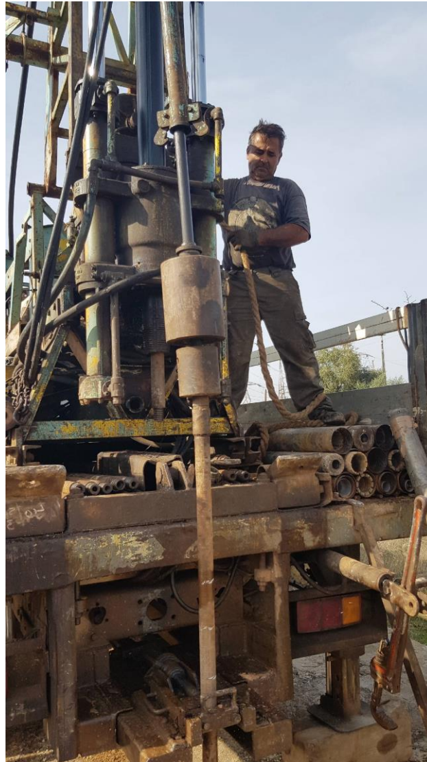
ΦΩΤ. 6 Εκτέλεση πρότυπης δοκιμής διείσδυσης - αυτόματα (SPT)
