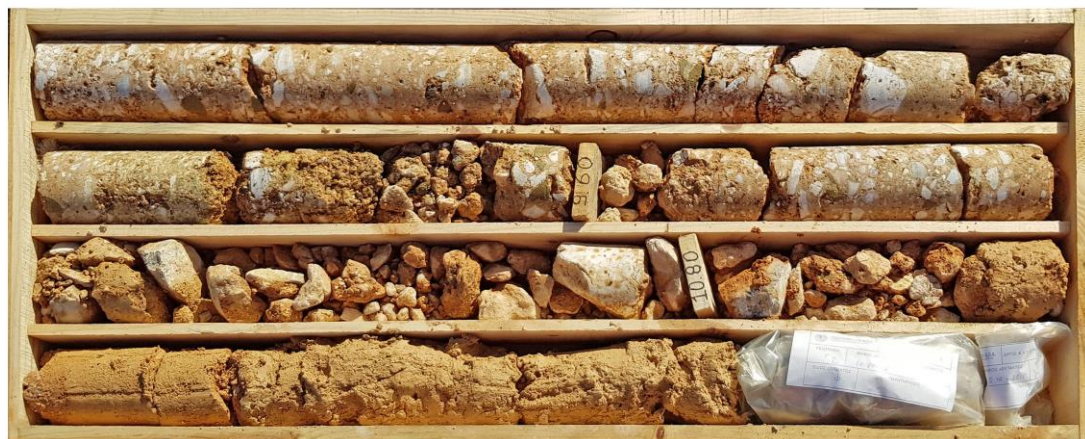
ΦΩΤ. 14 Δειγματοληψία γεώτρησης Γ2 (8,00-12,15 m)
