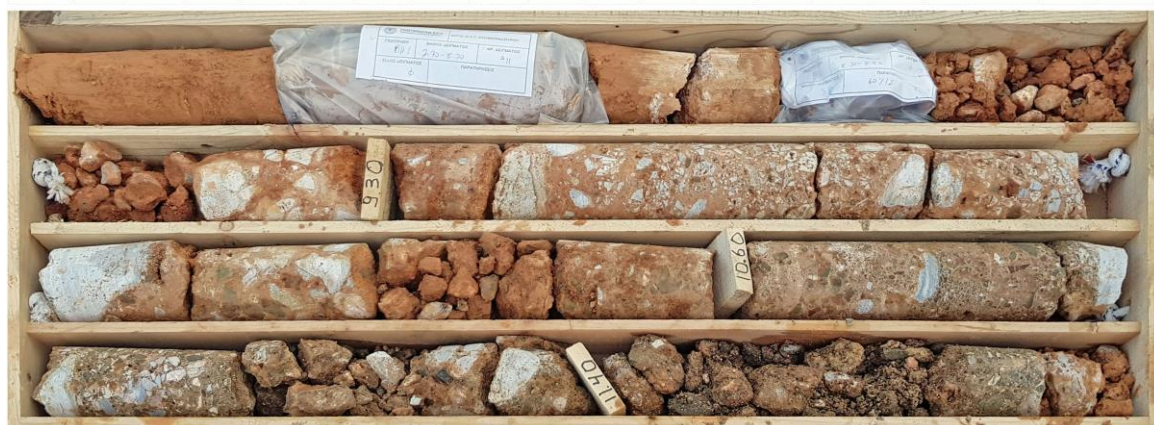
ΦΩΤ. 10 Δειγματοληψία γεώτρησης Γ1 (8,10-11,90 m)
