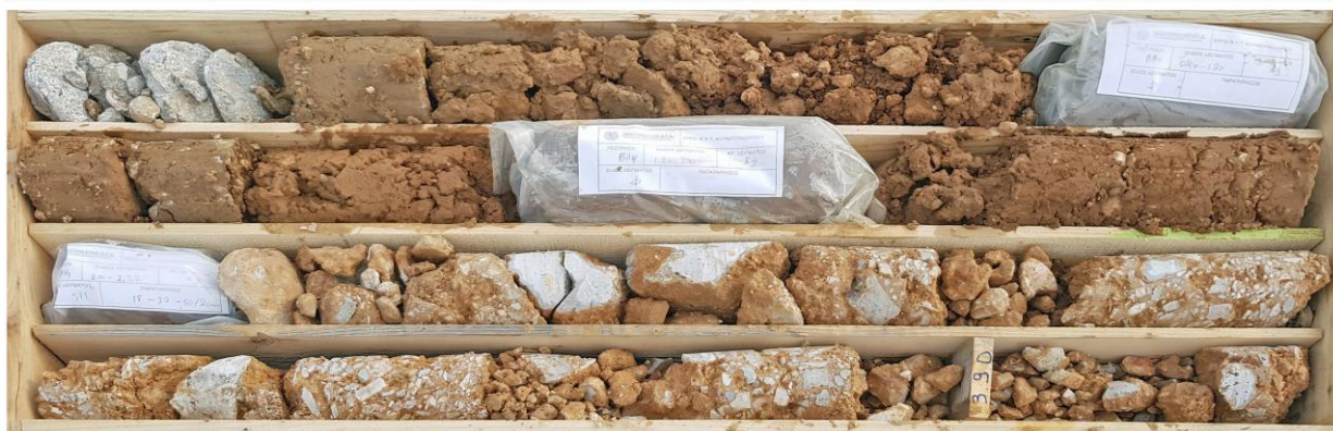
ΦΩΤ. 19 Δειγματοληψία γεώτρησης Γ4 (0,00-4,20 m)
