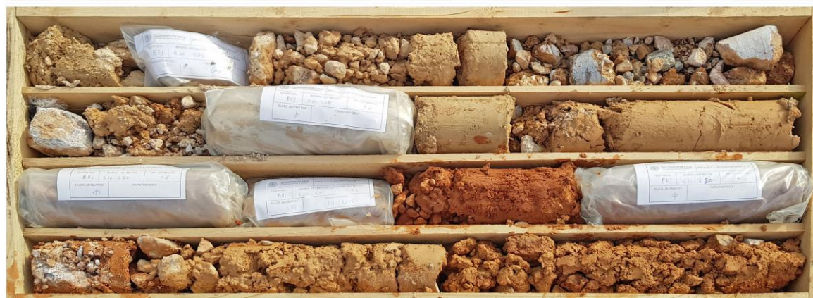
ΦΩΤ. 9 Δειγματοληψία γεώτρησης Γ1 (4,10-8,10 m)
