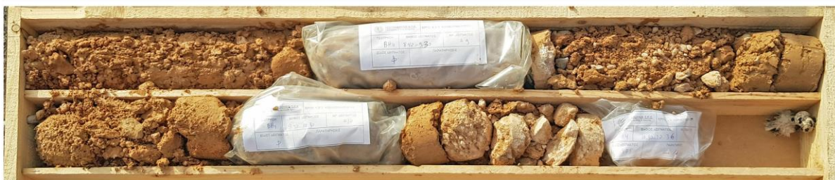
ΦΩΤ. 21 Δειγματοληψία γεώτρησης Γ4 (8,70-10,36 m)
